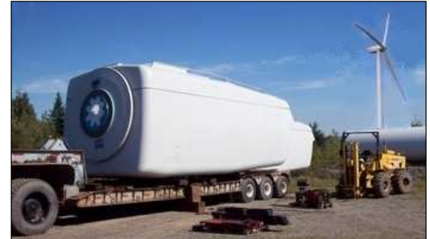
Nacelle d'éolienne-62 tonnes
